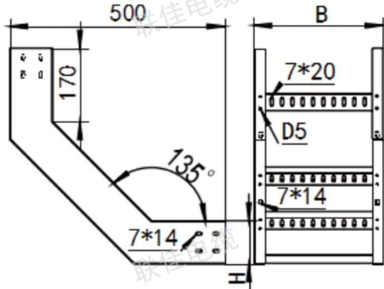
线槽平整无扭曲变形，内壁无毛刺，接缝处紧密平直，各种附件齐全。线槽连接口处应平整，接缝处紧密平直，槽盖装上应平整，无翘角，出线口位置正确。线槽经过变形缝时，线槽本身应断开，线槽内用连接板连接，不得固定，保护地线应有补偿余量，线槽CT300\*100以下与横亘固定1个螺栓，CT400\*100以上必须固定2个螺栓。非金属线槽所有非导电部分均应相应连接和跨接，使之成为一个整体，并做好整体连接。镀锌线槽间连接板的两端不跨接接地线，但连接板两端不小于2个有防松螺帽或防松垫圈的连接固定螺栓。槽式电缆桥架本身的封闭性能就很好，能够保护电力的运输。开孔式线槽规格
