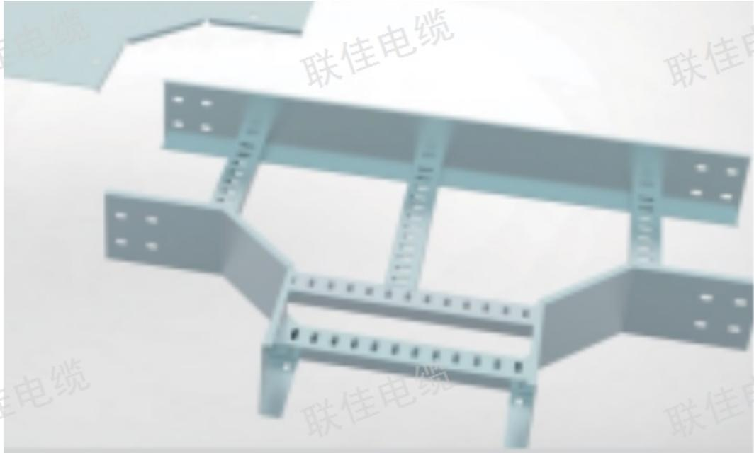
一种新型梯级式电缆桥架，包括第1侧板，镀锌层，宽度调节片，连接臂，所述第1侧板的中部设置有安装孔，所述第1侧板的底部安装有第1底板，所述第1侧板的侧面设置有所述连接臂，所述连接臂的侧面设置有第1安装板，所述连接臂的侧面设置有第二安装板，所述连接臂的中部设置有凹槽，所述连接臂的另一侧设置有第二侧板，所述第二侧板的底部设置有第二底板。有益效果在于：本实用新型降低了梯级式电缆桥架的总体重量，增强了底板的强度，避免了在使用时梯级式电缆桥架底板的应力集中情况，提高了梯级式电缆桥架的安全性和寿命降低。
